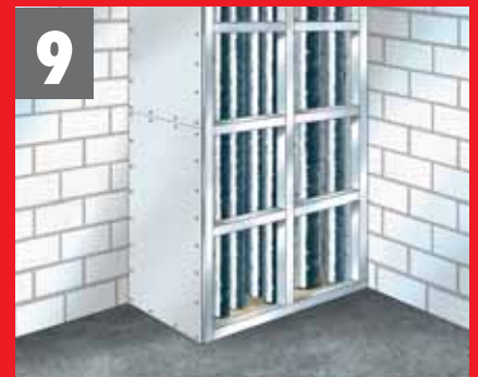
9 Nach Austrocknungs- und Aushärtezeit Schachtwand fachgerecht verkleiden. Mind. 18 mm Gipskartonplatte in Trockenbauweise gemäß DIN 4103 oder massive Wandkonstruktionen gemäß DIN 1053.
