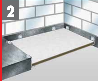
2 Montieren der Deckenplatte - mit Montagewinkeln oder Montageschiene
